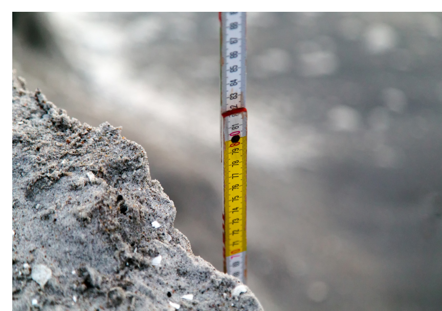
Die Böschung der Versuchsdüne wurde bei einem Vorversuch durch bis auf eine Höhe von 80 cm abgetragen.
