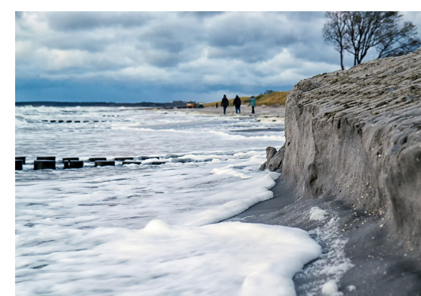
Sichtbare Erosion und Sedimentumlagerungen durch das Hochwasser an der Versuchsdüne in Ahrenshoop.
